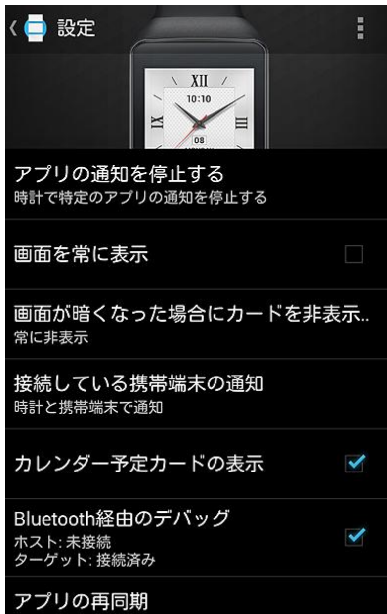
図 8 Bluetooth 経由のデバッグを有効にし、ターゲットと接続済みになっていることを確認
